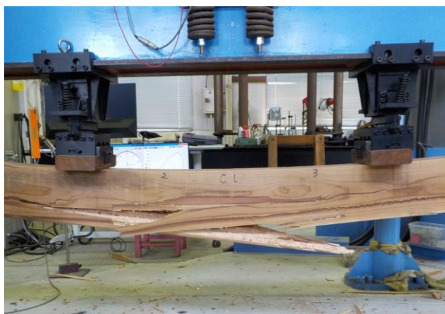
スギ心去り平角材の曲げ試験 (詳しくは2～3ページ)
