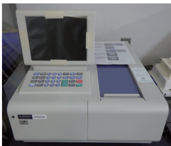
分光光度計を使ったホルムアルデヒド濃度の測定 (詳しくは5ページ)
