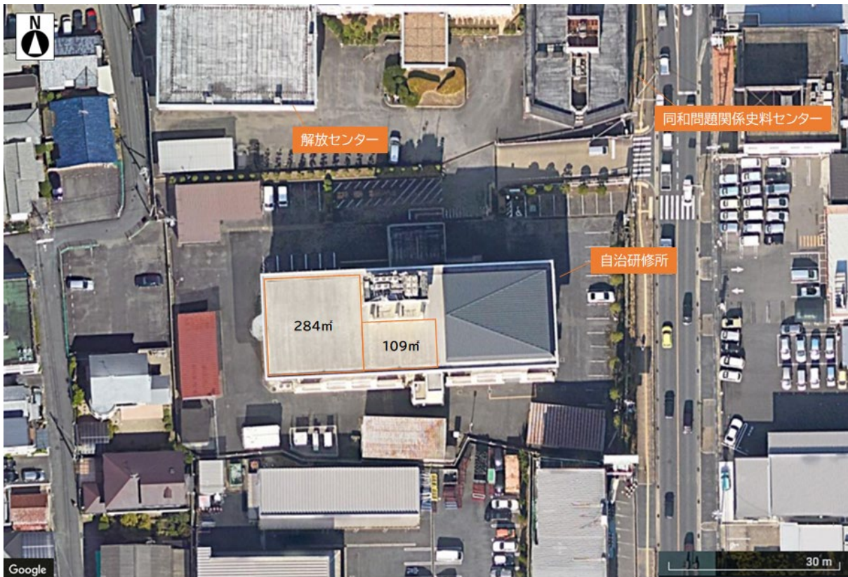
図 2 航空写真を用いた設置想定場所及び面積の簡易判断例
