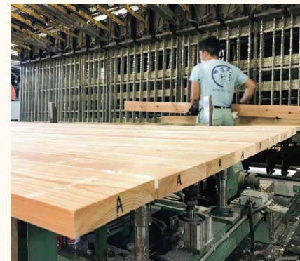
■接着が回ったら厚みを削り仕上げます。
