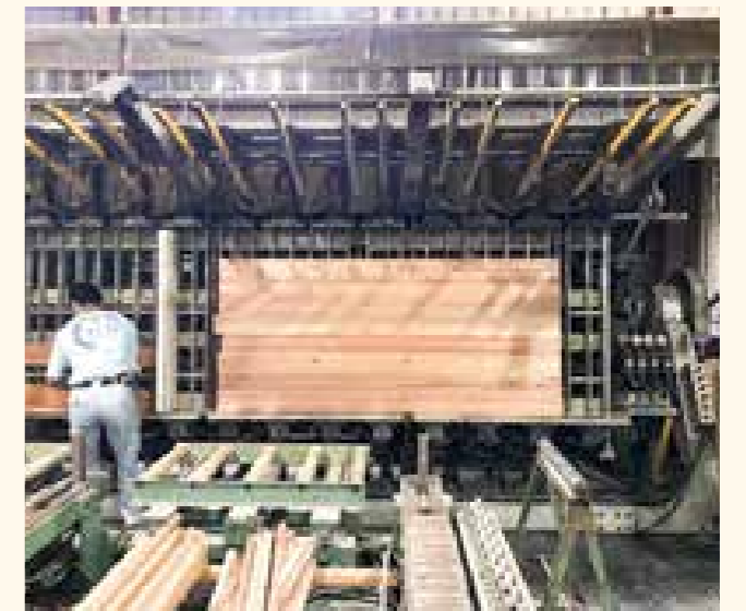
■吉野の製材所にてはぎ合わせをします。
