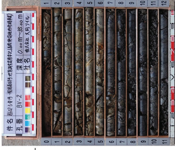
BV-2号コア写真。深度11.5mまで風化・ゆるみが見える
