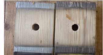
図4 ばく露後1年経過した辺材の無処理接合面
