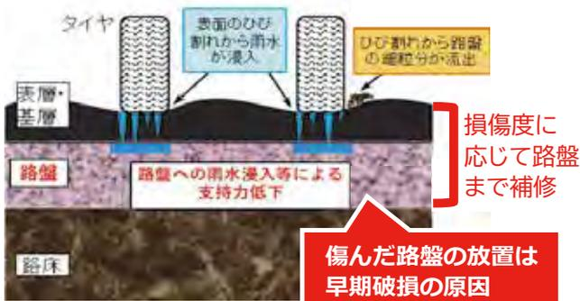
▲路盤が損傷するメカニズムと補修イメージ
