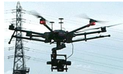
8 K 技術を活用したドローンによる ダム点検や災害時の広域監視
