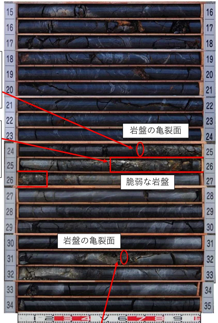
更なる被災が発生した場合、岩盤の亀裂面以上の地層が露出し、岩盤すべりを起こす危険性
