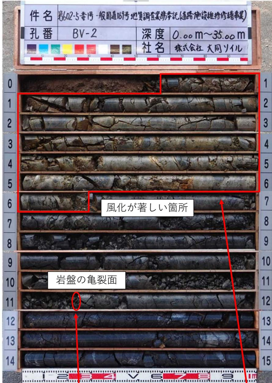
更なる被災が発生した場合、岩盤の亀裂面以上の地層が露出し、岩盤すべりを起こす危険性
