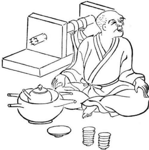
中世の轆轤師（『七十一番職人歌合』群書類従28） 僧形の轆轤師と手挽轆轤が描かれている。助手が轆轤の軸に巻かれた紐の両端を交互に引っ張って回転を与え、軸の端に取り付けられた材を轆轤師がカンナで削る。
