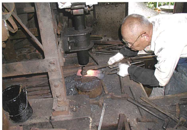
③ベルトハンマーによる成形
