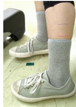
図4 ずり落ち実験：歩行動作後のソックスDがずり落ちた様子。
