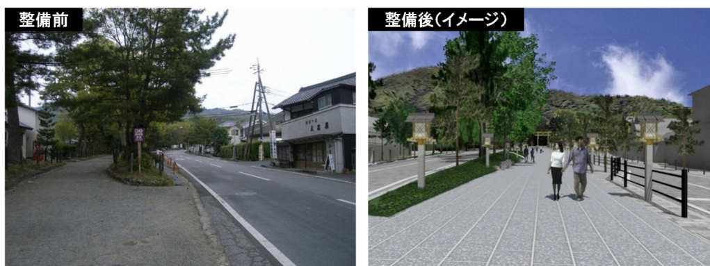
「県と市町村とのまちづくり」の観点に基づく無電柱化の整備事例（三輪山線）
