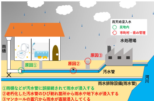
図一1 雨天時浸入水が発生する主な原因
