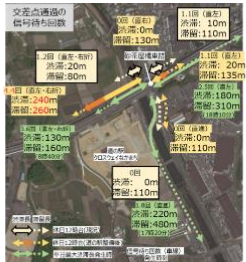
図7 当駅整備後の渋滞状況
