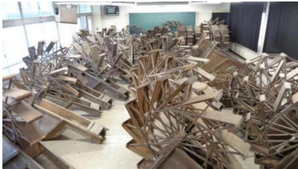
踏車(ふみぐるま) (田へ揚水する道具。水車を足で踏み、回転させることで、低所の水路から高所の田へ水を汲み揚げる。)
