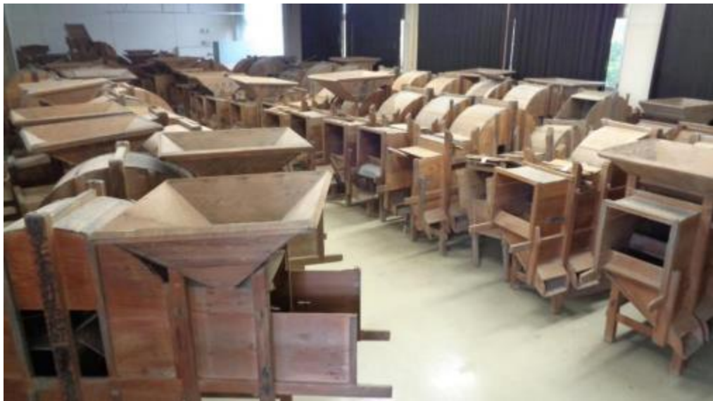
唐箕(とうみ) (穀物を上部逆三角から通し、風力で砂や塵などと分離する)
