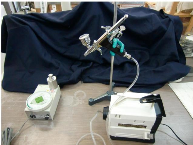
写真5 エアブラシを用いた簡易な回転式散布装置
