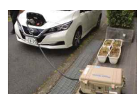
V2L(電気自動車用可搬型給電器)
