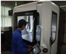
高性能な機械を自分たちで作成したプログラムで動かし、複雑な形状を正確に削る金属加工を行います。
