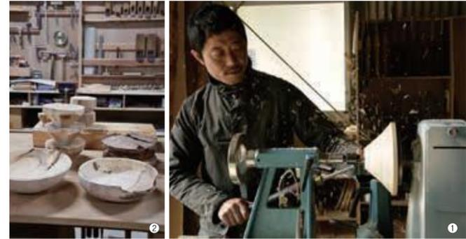
①ろくろのように器を回転させる旋盤(せんばん)を使用して、器の形を削り出していく ②削りたての器。天然オイルや草木染など自然の素材で仕上げている
