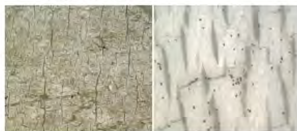
図 5 PP/CNF 暴露試験片(左: 6 か月, 右: 18 か月)の顕微鏡画像(100 倍)
