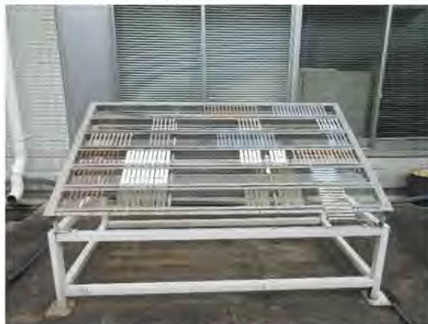
図 1 屋外暴露試験の様子
