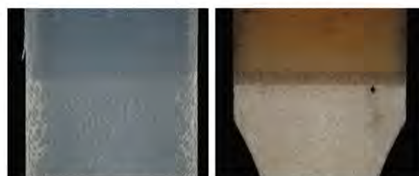
図 3 12 か月暴露試験片(左: PP, 右: PP/CNF)のマイクロスコープ画像(12 倍)
