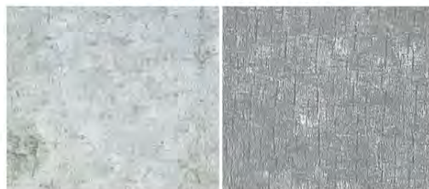
図 4 PP 暴露試験片(左: 6 か月, 右: 18 か月)の顕微鏡画像(100 倍)
