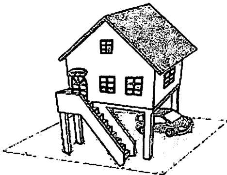
1階部分がピロティ形式になっている。
