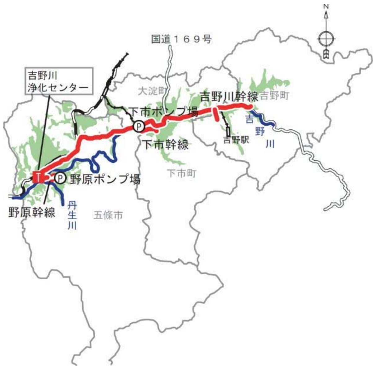
吉野川流域下水道（吉野川処理区）
