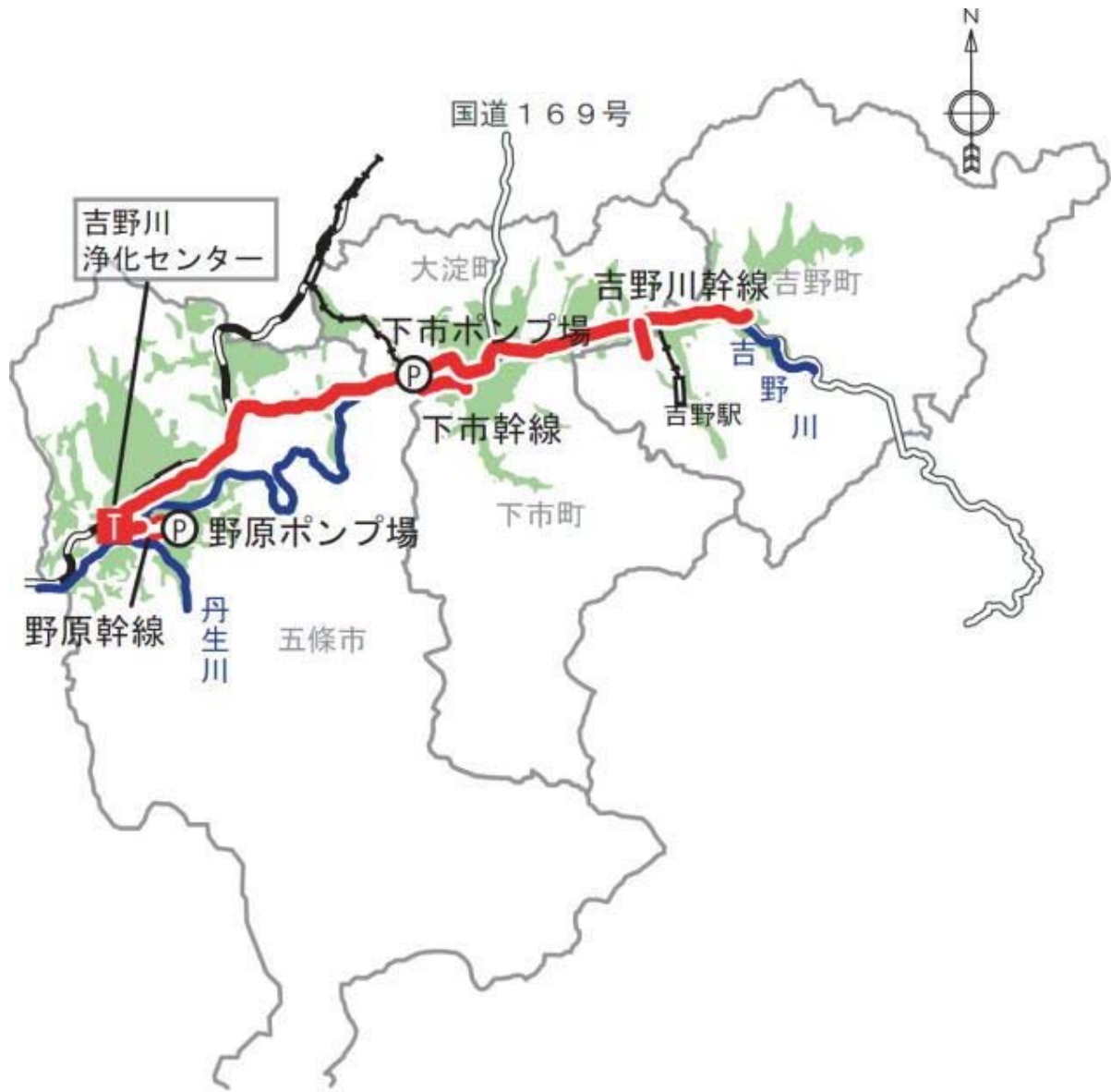
吉野川流域下水道（吉野川処理区）
