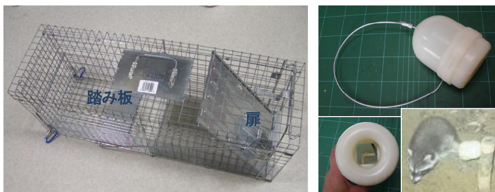
図 2-13 箱わな（左）、エッグトラップ（右）（近畿地方防除モデル事業より）
