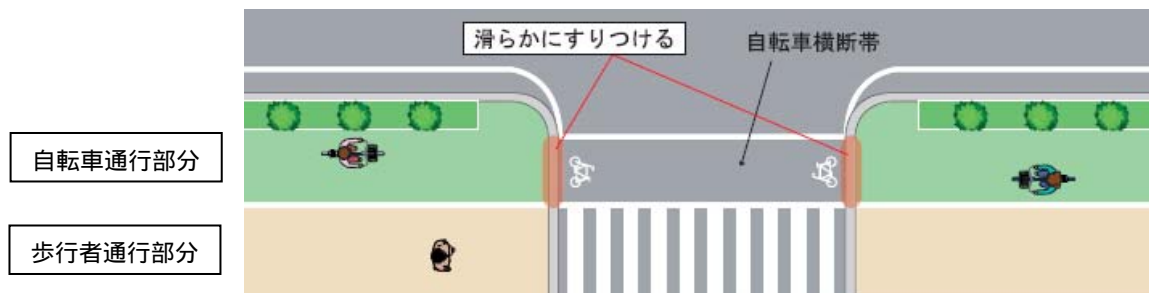
図 4.1 自転車横断帯のすり付け部分
