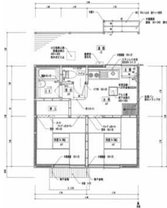
図 22 応急仮設住宅 9坪標準タイプ
