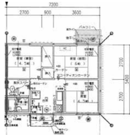
図 23 応急仮設住宅 12坪標準タイプ
